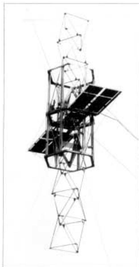
図2 トラスビームビルダー外観写真
